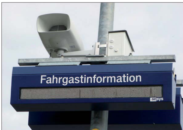
Abbildung 18: Auch der neue Schriftanzeiger in Wahlstedt hat im Gehäuse offensichtlich zu viel Feuchtigkeit.
