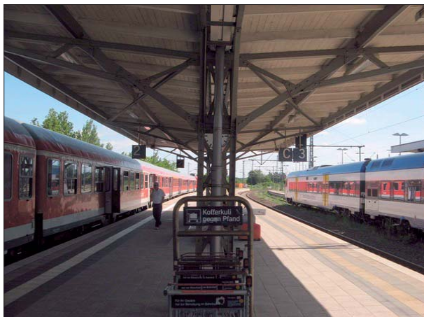
Abbildung 21: Die neuen Uhren in Itzehoe wurden ungünstig in der Mitte der Dächer platziert. Dadurch sind sie hinter den Dachstützen und Oberleitungsmasten nicht zu erkennen, wenn man den Bahnsteig erreicht.
