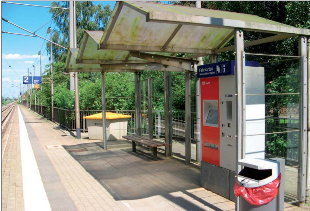
Krempe: Bahnhof an der Strecke Hamburg - Itzehoe: Der Bahnsteig Richtung Itzehoe. In Krempe gab es Glasschäden an der Lärmschutzwand und Verschmutzungen auch am Dach und an den Sitzbänken. Am Gleis 1 war zudem die Uhr verschwunden.
