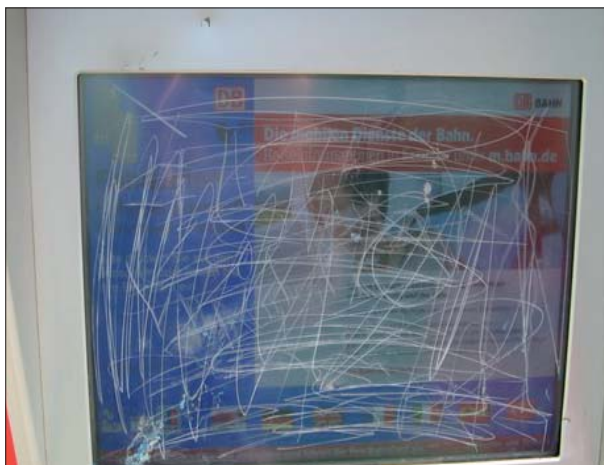
Abbildung 42: Der Bildschirm des Automaten am Gleis 2 in Krempe war so stark zerkratzt, dass die Touch-Screen-Funktion zerstört war.
