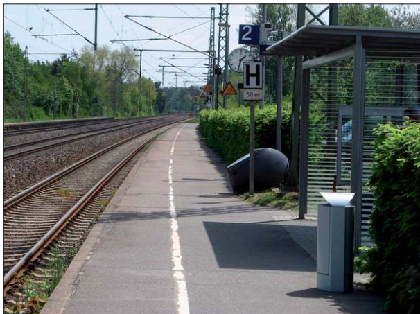
Abbildung 17: Die neuen Dynamischen Schriftanzeiger in Owschlag wurden beide schlecht platziert. Das Gerät am Gleis 2 wurde genau in den vom Dach des Unterstands abgedeckten Bereich auf einen neuen (!) Mast gesetzt.
