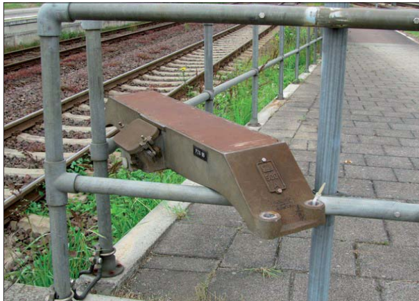
Abbildung 55: Dieser Zugsicherungsmagnet ist funktionslos am Geländer des Bahnsteigs an Gleis 3 in Itzehoe befestigt.
